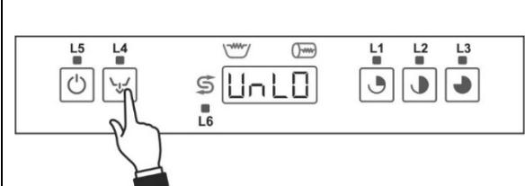
Нажать кнопку слива примерно на 5", включается светодиод и запускается фаза слива и авто-чистки. На дисплее отображается "UnLoad". Если светодиод не мигает, программа не запустилась, и резистор бойлера отключен.
