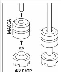
Перед тем, как вставить трубы в резервуары, закрепить на концах груз (необходимый для удержания трубы подачи на дне) и фильтр как указано на картинке. Если дозатор моющего средства не установлен изначально, его можно установить заказав соответствующий набор деталей.
