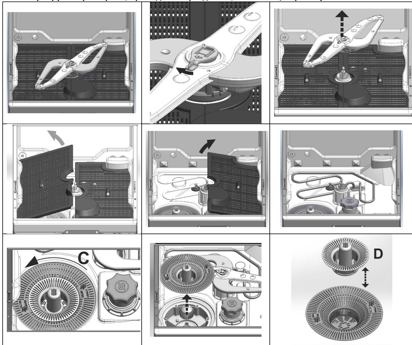
Процедура демонитрования фильтров с двумя фильтрующими элементами:
