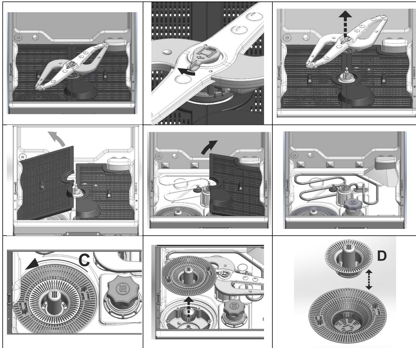
Процедура демонитрования фильтров с двумя фильтрующими элементами:
