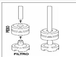
Перед тем, как вставить трубки в резервуары, закрепить на концах груз (необходимый для удержания трубки подачи на дне) и фильтр как указано на картинке. Если дозатор моющего средства не установлен изначально, его можно установить заказав соответствующий набор деталей.
