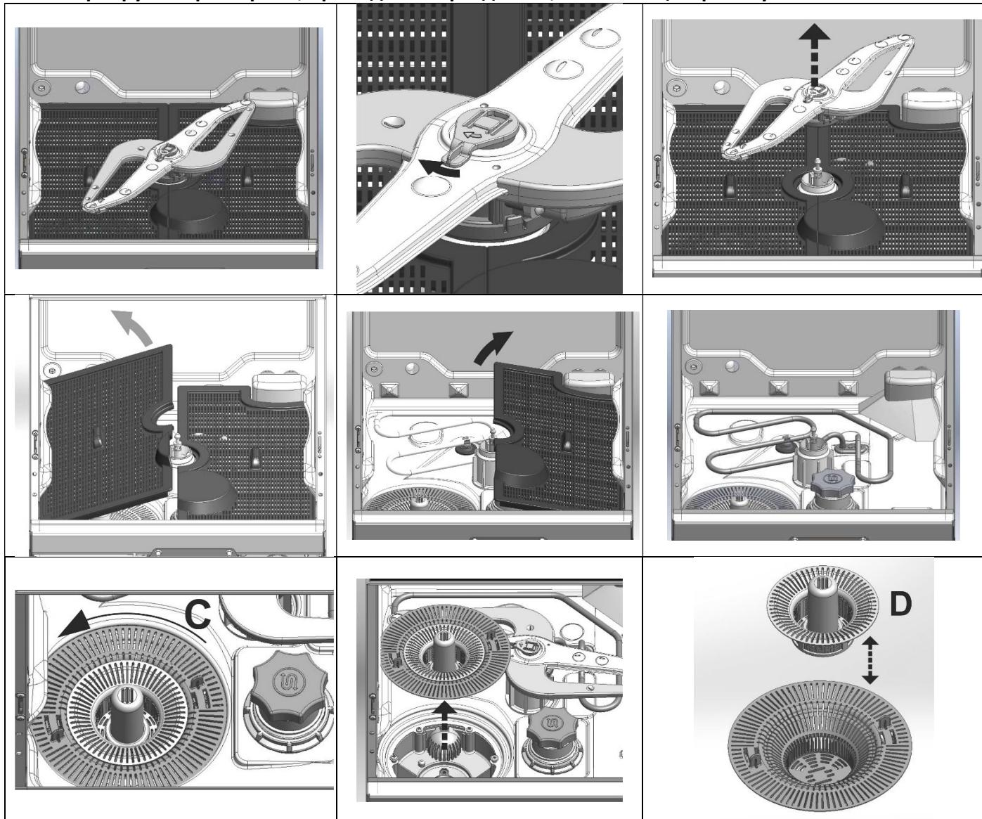
Процедура демонитрования фильтров с двумя фильтрующими элементами:
