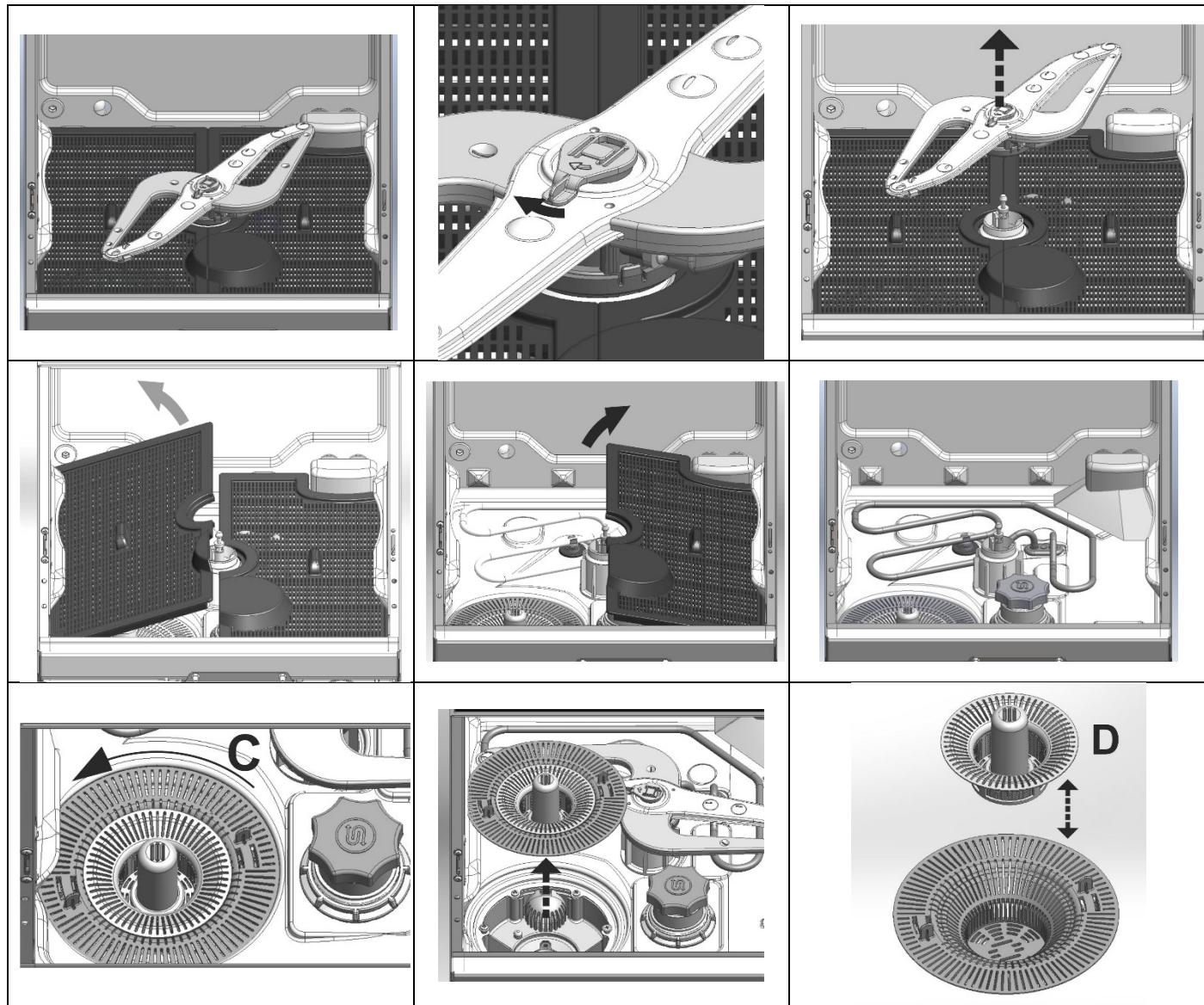
**Процедура демонитрования фильтров с двумя фильтрующими элементами:**
