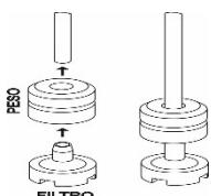
Перед тем, как вставить трубы в резервуары, закрепить на концах груз (необходимый для удержания трубы подачи на дне) и фильтр как указано на картинке. Если дозатор моющего средства не установлен изначально, его можно установить заказав соответствующий набор деталей.
