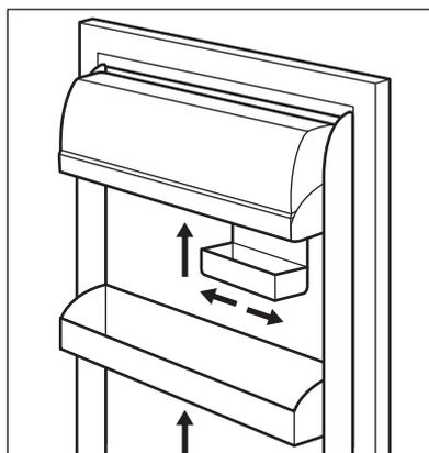
Este modelo está equipado com uma caixa de arrumação variável, que pode ser deslizada lateralmente.
