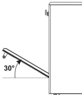
3. Чтобы снова установить дверцу, вставьте шарниры в соответствующие пазы, расположенные на духовке, так чтобы шлицы **A** полностью вошли в пазы. Опустите дверцу вниз, установите ее и извлеките блокирующие крючки из отверстий петель.
