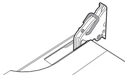
2. Возьмите дверцу за обе стороны двумя руками, приподнимите ее под углом приблизительно  $30^\circ$  и выньте.
