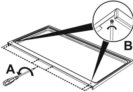
2. Установите планку на поверхности панели. Совместите 6 отверстий на нижней части планки с ранее ослабленными 6 винтами на задней части панели.
