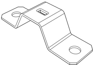
В случае двухфазного или трехфазного подключения, для правильного крепления кабеля, необходимо заменить уже установленный мостик на мостик из комплекта поставки.
