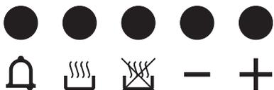
**i** Часы с программатором предназначены исключительно для контроля нижней левой многофункциональной духовки и не функционируют с другими духовками.
