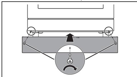
3. Fixe o rodapé frontal do aparelho através dos parafusos anteriormente retirados.
