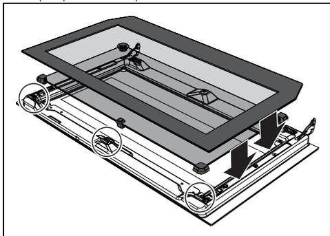
7. Para reposicionar o vidro interior, introduza a parte da frente nos cliques da porta e encaixe os 2 pernos posteriores nas suas cavidades com uma ligeira pressão.
