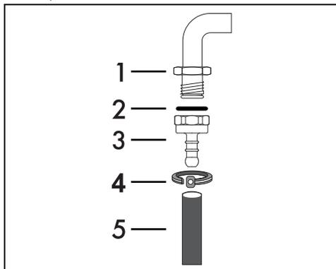
Enrosque de forma precisa o adaptador de mangueira 3 à ligação de gás 1 (rosca de 1/2" ISO 228- 1) do aparelho interpondo o vedante 2. Depois de ter fechado o adaptador de mangueira, encaixe o tubo de gás 5 ao adaptador e fixe-o com a braçadeira 4 conforme a norma vigente.
