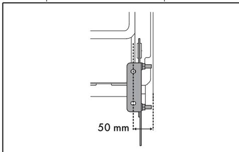
7. Desloque o suporte na parede e marque a posição dos furos a realizar na parede.
