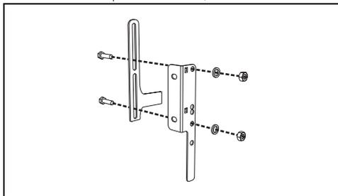
4. Alinhe a base do gancho do suporte de fixação à base do corte da pequena chapa de fixação à parede.
