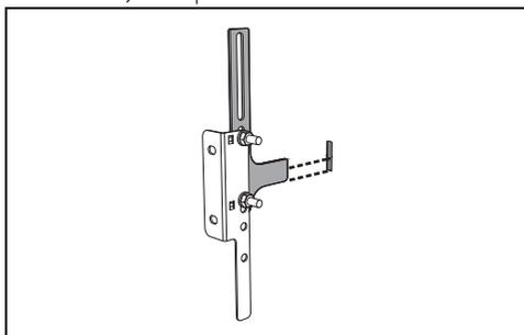
5. Alinhe a base do suporte de fixação ao pavimento e aperte os parafusos para fixar as medidas.
