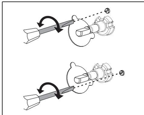
Acenda o queimador e coloque-o na posição de mínimo. Extraia o botão da torneira de gás e rode o parafuso de ajuste que se encontra ao lado da haste da torneira (conforme os
