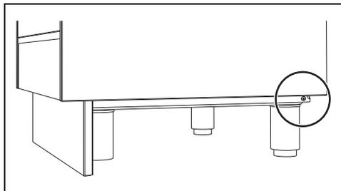
2. Posicione o rodapé lateral na parte inferior lateral do aparelho, abaixo da estufa.
