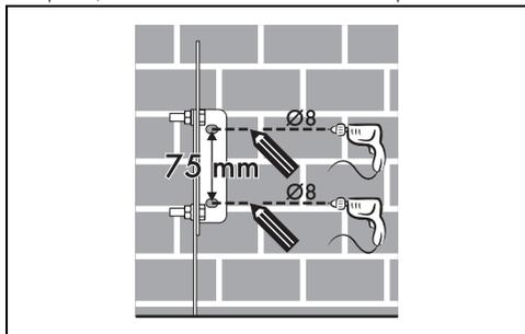
8. Após realizar os furos na parede, utilize as buchas com parafusos para fixar o suporte à parede.
