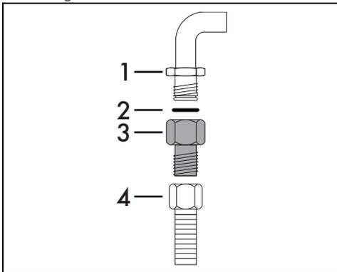
Enrosque de forma precisa a conexão 3 à conexão de gás 1 (rosca de 1/2" ISO 228- 1) do aparelho interpondo sempre o vedante 2 fornecido. Aplique material isolante na rosca da conexão 3, depois enrosque o tubo flexível em aço 4 à conexão 3.
