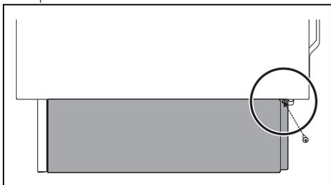
5. Fixe o rodapé lateral do aparelho através do parafuso anteriormente retirado.
