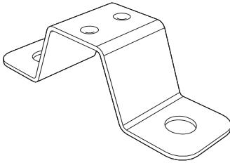
В случае подключения посредством кабеля с внутренним сечением на 10 кв. мм для его правильного крепления необходимо заменить уже установленную скобу на скобу из комплекта поставки.
