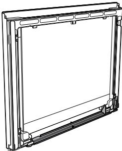
4. Завершив очистку, вставьте внутреннее стекло в кронштейны. Правильно центрируйте 4 стержня, а затем установите их в соответствующих гнездах на дверце. Чтобы обеспечить правильную установку используйте планки справа и слева.
