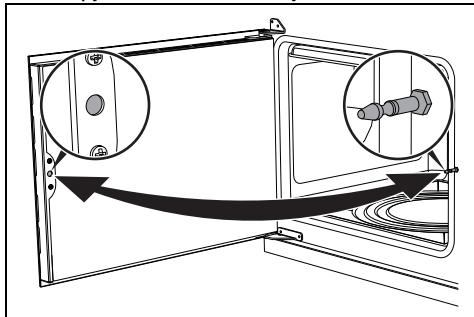
Многофункциональные духовки оснащены дверцами с открытием бокового типа. Чтобы открыть дверцу, необходимо потянуть ручку на себя. Чтобы закрыть дверцу духовки, необходимо нажать на нее до тех пор, пока не раздастся механический звук щелчка.
