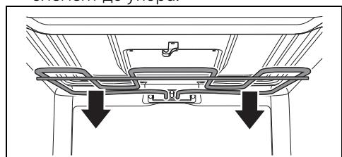
3. По окончании операции по очистке верните нагревательный элемент на место и поверните стопор для блокировки.
