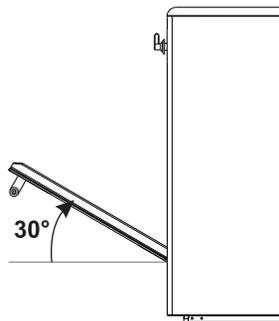
3. Per rimontare la porta inserire le cerniere nelle apposite fessure poste sul forno assicurandosi che le scanalature **A** si appoggino completamente alle fessure. Abbassare la porta verso il basso e una volta posizionata rimuovere i ganci di bloccaggio dai fori delle cerniere.
