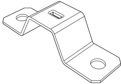
Nel caso di collegamento bifase o trifase, per un corretto fissaggio del cavo, è necessario sostituire il cavallotto già installato con il cavallotto in dotazione.
