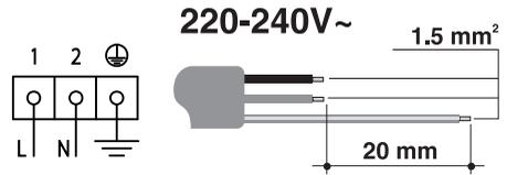
Cavo **tripolare 3 x 1,5 mm<sup>2</sup>**.
