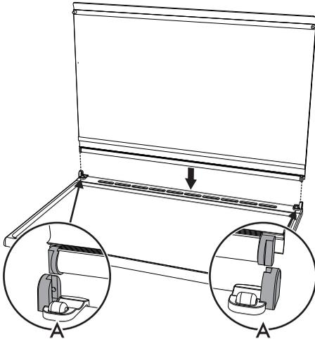
4. Fissare il coperchio al piano cottura tramite le viti **C** inserite nella parte posteriore dei due supporti **A**.
