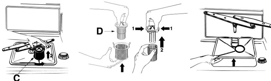
**ОЧИСТКА ФИЛЬТРУЮЩЕГО УЗЛА (модели с планетарным распылителем)**
