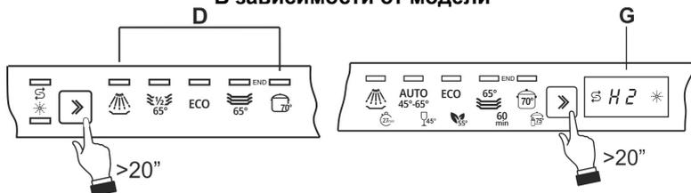
Если после выполнения регулировки или просмотра заданного значения не касаться кнопки в течение нескольких секунд, посудомоечная машина автоматически выйдет из режима регулировки и вернется в стандартный режим работы.
