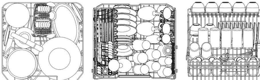
**Если вставки нижней корзины наклонные, опустите их для облегчения загрузки.**
