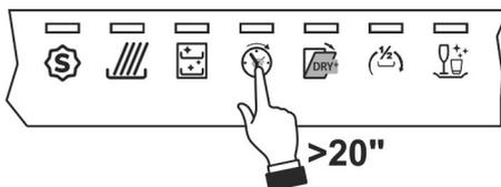
Após a realização do ajuste ou a visualização da definição atual, se não tocar no botão durante alguns segundos; a máquina sairá automaticamente do modo de ajuste e voltará ao modo de funcionamento padrão.
