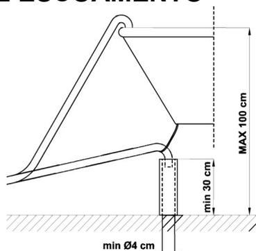
É importante evitar que a mangueira possa desengatar-se e cair. Por isso, o suporte para mangueira possui um furo, graças ao qual é possível fixá-lo com um laço à parede ou à torneira. A extremidade livre deverá ficar colocada numa altura entre **30 e 100 cm** e nunca deverá ficar imersa em água. Quando existirem mangueiras com extensões dispostas horizontalmente, num máximo de 3 m, posicione a mangueira de escoamento a uma altura máxima de **85 cm** do chão.
