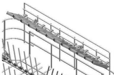
**Glass holder.** Suporte para copos de pé alto. Ao ser levantado, roda da posição de descanso (0) e pode ser bloqueado por encaixe em três posições diferentes (1-2-3).
