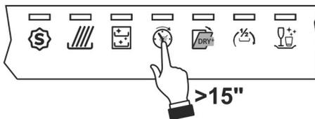
Após a realização do ajuste ou a visualização da definição atual, se não tocar no botão durante alguns segundos; a máquina sairá automaticamente do modo de ajuste e voltará ao modo de funcionamento padrão.
