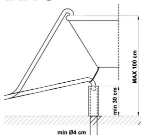
In presenza di tubi di prolunga disposti orizzontalmente, per un massimo di 3 m, posizionare il tubo di scarico ad un'altezza max. di **85 cm** dal suolo.
