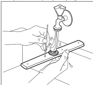
4. Для установки разбрызгивателя на место установите фиксатор в разбрызгиватель и закрепите его на трубе подачи воды, повернув против часовой стрелки. Убедитесь, что фиксатор защелкнулся.
