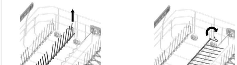
Insertos “quebra-gotas” para melhorar a secagem dos pratos. Podem estar montados no cesto ou colocados no saco de acessórios. Neste último caso, para os utilizar, é suficiente introduzi-los nas sedes próprias, conforme indicado na figura.
