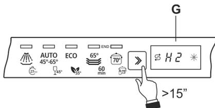
Após a realização do ajuste ou a visualização da definição atual, se não tocar no botão durante alguns segundos; a máquina sairá automaticamente do modo de ajuste e voltará ao modo de funcionamento padrão.
