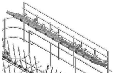
**Glass holder.** Suporte para copos de pé alto. Ao ser levantado, roda da posição de descanso (0) e pode ser bloqueado por encaixe em três posições diferentes (1-2-3).
