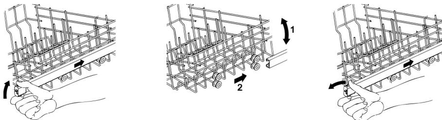
**Versão B:** com ajuste em **três posições** em ambos os lados.
