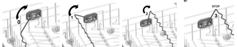
Suportes rebatíveis de 2 posições (1-2). Na posição 1 (vertical) podem ser utilizados para dispor os pratos e na posição 2 (inclinada), para apoiar os copos de pé alto que ficarão suportados pelo **glass holder**. Regulação: levante o ponto **P** conforme indicado até o suporte rodar para a posição 2.
