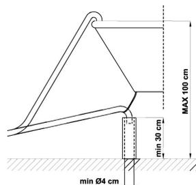
При наличии горизонтально уложенных удлинительных шлангов с максимальной длиной 3 м разместите сливную шланг на высоте, составляющей максимум **85 см** от пола.
