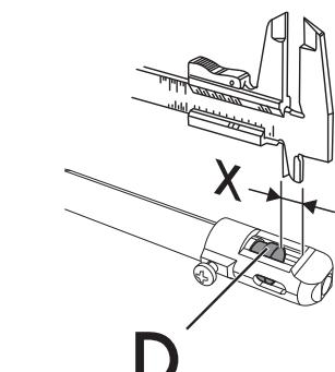
10. Отрегулируйте приток воздуха, сдвинув трубку Вентури "D" до получения расстояния "X", указанного в соответствующих таблицах (см. "Таблицу характеристик конфорок и форсунок", пункт "Первичный воздух [мм]", и закрепите ее винтом "A".
