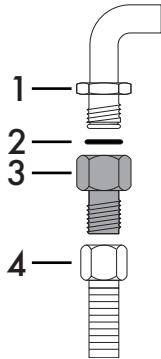
Аккуратно привинтите фитинг 3 к газовому патрубку 1 (резьба  $\frac{1}{2}$  дюйма ISO 228-1) прибора, проложив прокладку 2 из комплекта поставки. Нанесите изоляционный материал на резьбу патрубка 3, а затем заверните гибкий стальной шланг 4 на патрубке 3.
