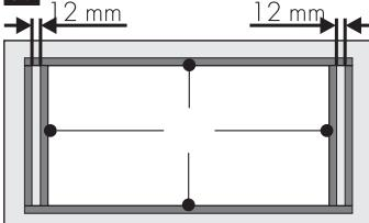
Чтобы правильно закрепить варочную панель на тумбе для встраивания, ввинтите крепежные кронштейны в специальные отверстия.
