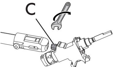
8. С помощью жесткого ключа снимите форсунки "C" и установите форсунки, подходящие для нового типа газа, следуя указаниям, приведенным в соответствующих таблицах (см. «Типы газа и страны принадлежности»).
