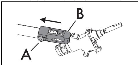
7. Отвинтите винт "A" и протолкните до упора регулятор воздуха "B".
