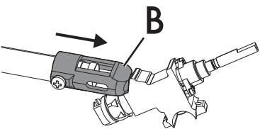
9. Установите держатель "B" в начальное положение так, чтобы полностью покрыть форсунку "C".
