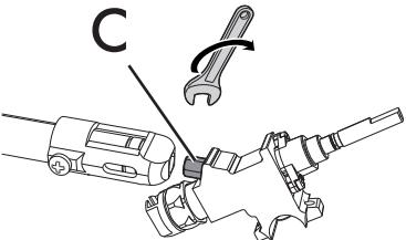
8. С помощью жесткого ключа снимите форсунки "C" и установите форсунки, подходящие для нового типа газа, следуя указаниям, приведенным в соответствующих таблицах (см. «Типы газа и страны принадлежности»).
