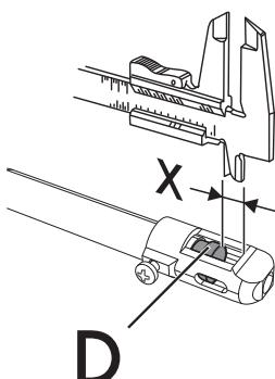
10. Отрегулируйте приток воздуха, сдвинув трубку Вентури "D" до получения расстояния "X", указанного в соответствующих таблицах (см. "Таблицу характеристик конфорок и форсунок", пункт "Первичный воздух [мм]", и закрепите ее винтом "A".
