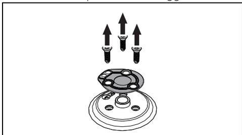
5. Rimuovere la guarnizione presente sulle termocoppie e candele da ogni bruciatore.
