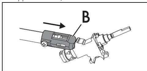
9. Riportare il supporto "B" nella posizione iniziale, in modo da coprire completamente l'ugello "C".
