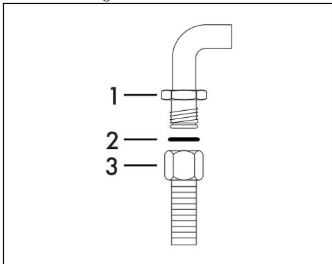
Avvitare accuratamente il raccordo 3 al raccordo gas 1 dell'apparecchio interponendo sempre la guarnizione 2 in dotazione.
