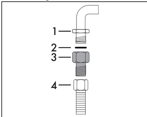
Avvitare accuratamente il raccordo 3 al raccordo gas 1 (filetto 1/2" ISO 228-1) dell'apparecchio interponendo sempre la guarnizione 2 in dotazione. Applicare del materiale isolante sul filetto del raccordo 3, dopodiché avvitare il tubo flessibile in acciaio 4 al raccordo 3.
