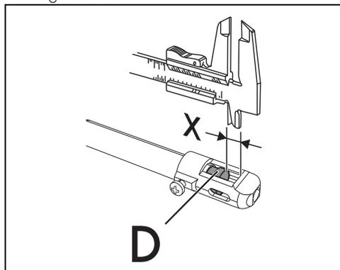
10. Regolare l'afflusso d'aria spostando il tubo Venturi "D", fino ad ottenere la distanza "X" riportata nelle tabelle relative (vedi "Tabella caratteristiche bruciatori e ugelli", alla voce "Aria primaria (mm)"); successivamente, stringere la vite "A".
