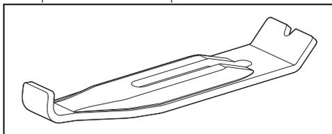
Avvitare le staffe di fissaggio negli appositi fori per fissare correttamente il piano cottura alla struttura d'incasso.
