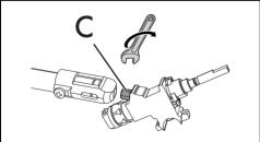
С помощью жесткого ключа снимите форсунки "С" и установите форсунки, подходящие для нового типа газа, следуя указаниям, приведенным в соответствующих таблицах (см. «Типы газа и страны принадлежности»).
