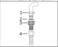
Аккуратно привинтите фитинг 3 к газовому патрубку 1 (резьба ½ дюйма ISO 228-1) прибора, проложив прокладку 2 из комплекта поставки. Нанесите изоляционный материал на резьбу патрубка 3, а затем заверните гибкий стальной шланг 4 на патрубке 3.
