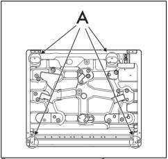
Вкрутите крепежные скобы в соответствующие отверстия, чтобы правильно закрепить варочную панель на встроенной конструкции.
