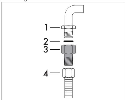
Enrosque de forma precisa a conexão 3 à conexão de gás 1 (rosca de 1/2" ISO 228-1) do aparelho interpondo sempre o vedante 2 fornecido. Aplique material isolante na rosca da conexão 3, depois enrosque o tubo flexível em aço 4 à conexão 3.
