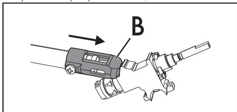
9. Volte a colocar o suporte "B" na posição inicial, de forma a cobrir completamente o injetor "C".
