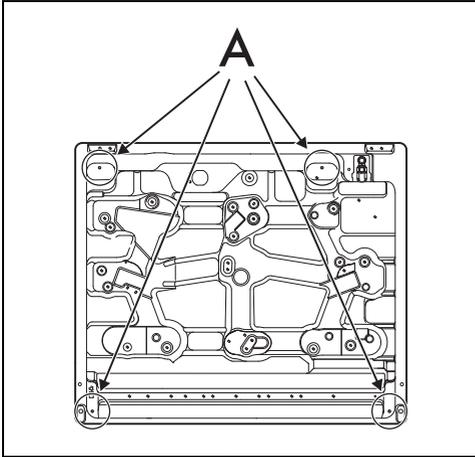
Aperte os suportes de fixação nos respectivos furos para fixar corretamente a placa de cozinha à estrutura de encastre.
