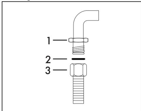
Enrosque de forma precisa a conexão 3 à conexão de gás 1 do aparelho, interpondo sempre o vedante 2 fornecido.
