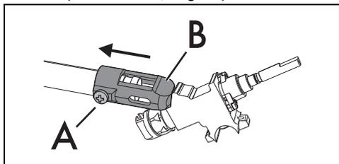
7. Desaperte os parafusos "A" e empurre a fundo o regulador de ar "B".
