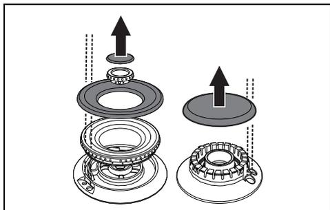
Antes de ligar os queimadores da placa, assegure-se de que os espalhadores estão colocados nas suas bases com as respetivas tampas. Tenha em atenção que os orifícios dos queimadores correspondam às velas e aos termopares. Verifique também se os encaixes
