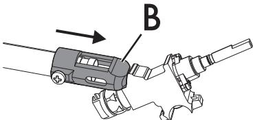
9. Установите держатель "B" в начальное положение так, чтобы полностью покрыть форсунку "C".
