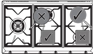
Во время приготовления пищи, чтобы избежать ожогов, повреждение варочной панели или столешницы, все емкости или сковороды-грили должны быть расположены в пределах períметра варочной панели.
