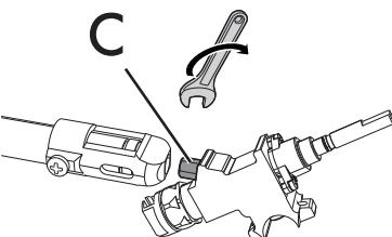
8. С помощью жесткого ключа снимите форсунки "C" и установите форсунки, подходящие для нового типа газа, следуя указаниям, приведенным в
