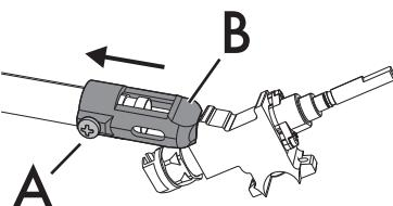
7. Отвинтите винт "A" и протолкните до упора регулятор воздуха "B".
