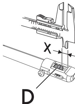
10. Отрегулируйте приток воздуха, сдвинув трубку Вентури "D" до получения расстояния "X", указанного в соответствующих таблицах (см. «Таблицу характеристики конфорок и форсунок», пункт «Первичный воздух (мм)», и закрепите ее винтом "A".
