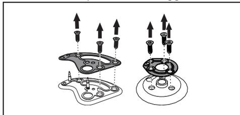
5. Rimuovere la guarnizione presente sulle termocoppie e candele da ogni bruciatore.
