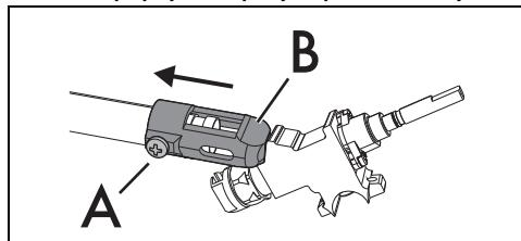
6. Отвинтите винт "A" и протолкните до упора регулятор воздуха "B".
