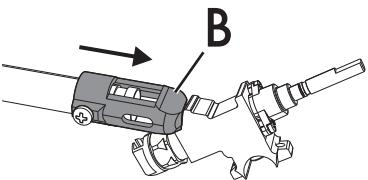
8. Установите держатель "B" в начальное положение так, чтобы полностью покрыть форсунку "C".
