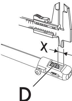
9. Отрегулируйте приток воздуха, сдвинув трубку Вентури "D" до получения расстояния "X", указанного в соответствующих таблицах (см. "Таблицу характеристик конфорок и форсунок", пункт "Первичный воздух (мм)", и закрепите ее винтом "A".
