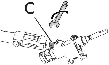
7. С помощью жесткого ключа снимите форсунки "C" и установите форсунки, подходящие для нового типа газа, следуя указаниям, приведенным в соответствующих таблицах (см. «Типы газа и страны принадлежности»).
