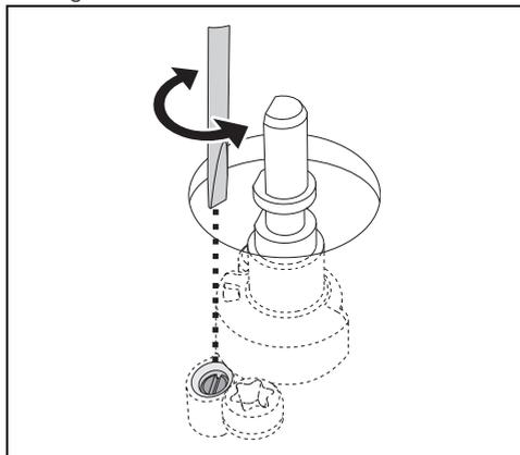
3. Vuelva a montar el mando y compruebe la estabilidad de la llama del quemador.
