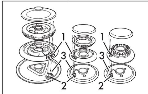
Antes de encender los quemadores de la encimera, verifique que los difusores de llama estén colocados en sus alojamientos con sus tapas correspondientes. Asegúrese de que los orificios 1 de los difusores de llama coincidan con las bujías 3 y los termopares 2. Controle además que los acoples de los difusores de llama se introduzcan correctamente en los agujeros del quemador.
