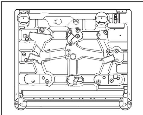
Atornille las abrazaderas de fijación en los orificios indicados para fijar correctamente la encimera de cocción a la estructura empotrada.
