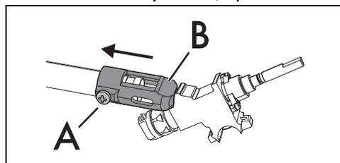
6. Afloje el tornillo "A" y empuje hasta el fondo el regulador del aire "B".
