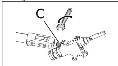
7. Con una llave fija quite los inyectores C y monte los adecuados al nuevo tipo de gas, siguiendo las indicaciones en las
