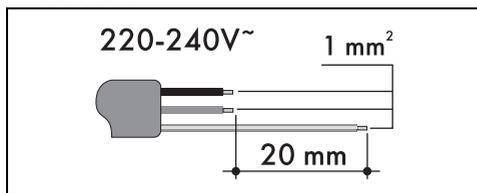
Los valores indicados más arriba se refieren a la sección del conductor interno.
