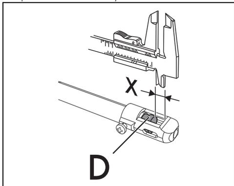
9. Ajuste la entrada de aire desplazando el tubo Venturi "D", hasta obtener la distancia "X" que figura en las tablas correspondientes (vea "Tabla de características de los quemadores e inyectores", en la opción "Aire primario (mm)"); a continuación, apriete el tornillo "A".
