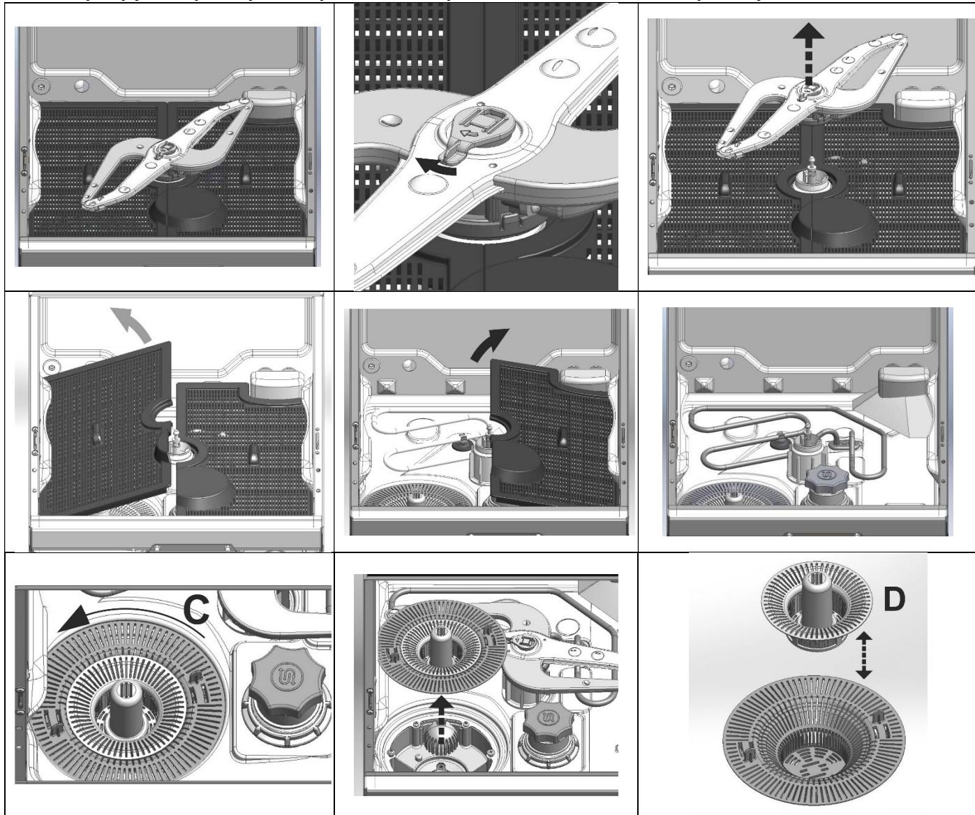
Процедура демонитрования фильтров с двумя фильтрующими элементами:
