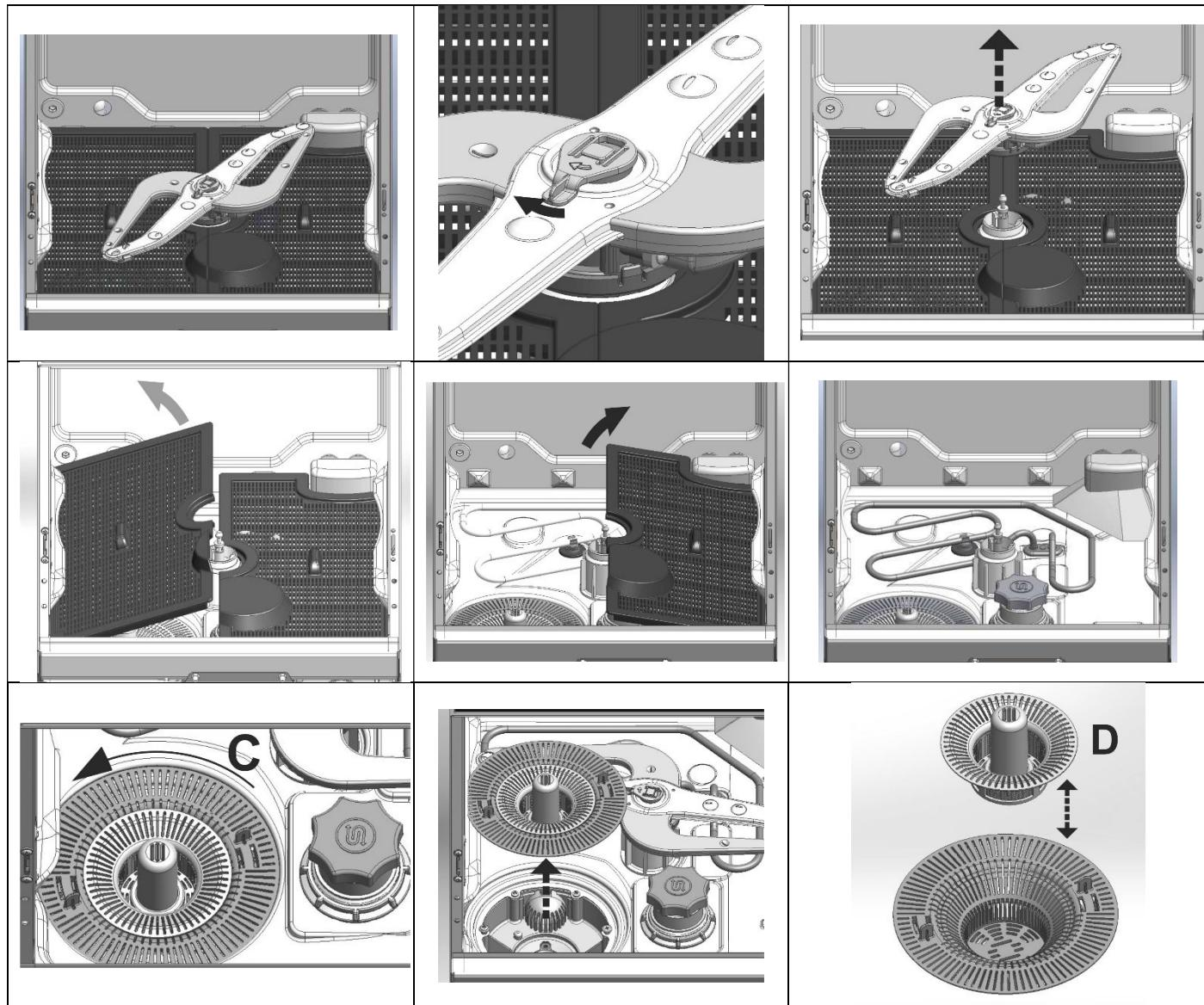
**Процедура демонитрования фильтров с двумя фильтрующими элементами:**
