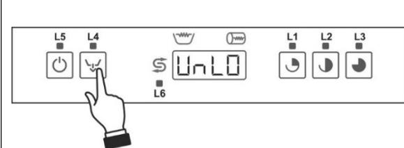
Нажать кнопку слива примерно на 5", включается светодиод и запускается фаза слива и авто-чистки. На дисплее отображается "UnLoad". Если светодиод не мигает, программа не запустилась, и резистор бойлера отключен.
