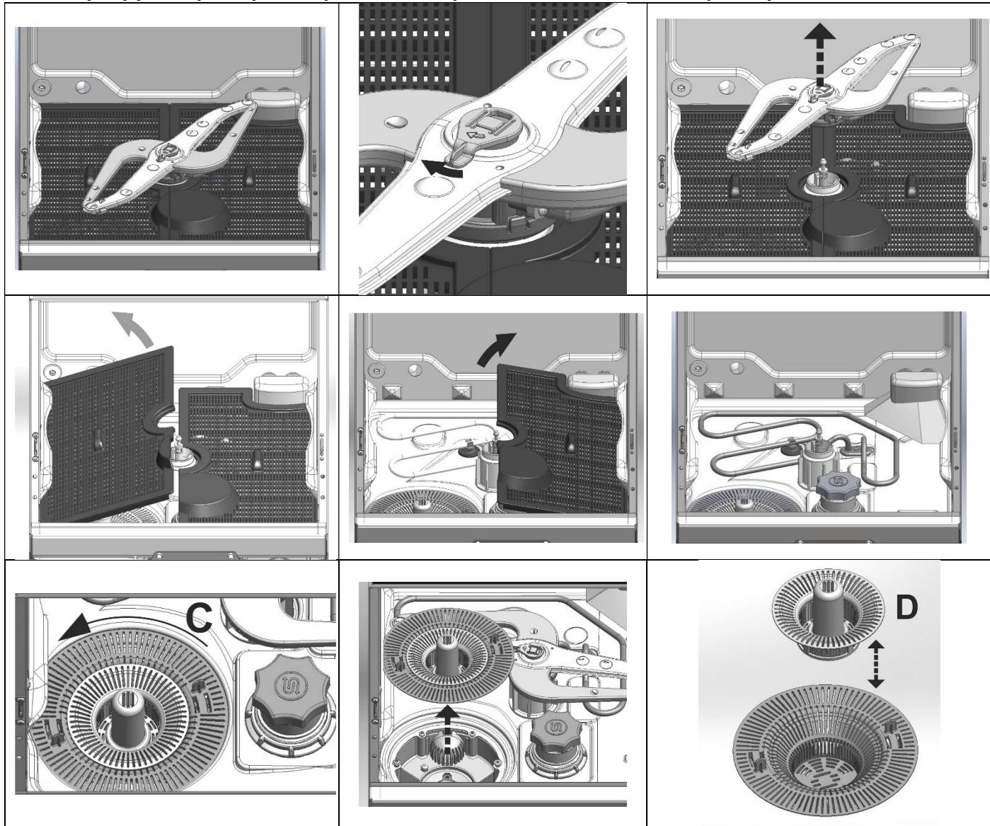
Процедура демонитрования фильтров с двумя фильтрующими элементами:
