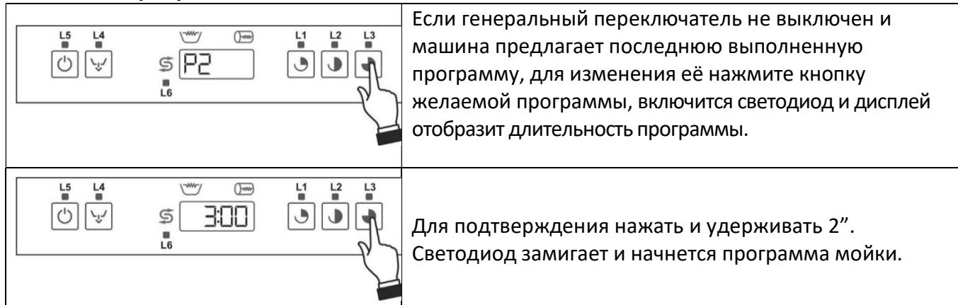
Если какая-то программа уже выполняется, её можно изменить сначала поставив машину на паузу (нажимая одну из этих кнопок на 2"), и затем выбрав желаемую программу.
