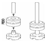
Перед тем, как вставить трубы в резервуары, закрепить на концах груз (необходимый для удержания трубы подачи на дне) и фильтр как указано на картинке. Если дозатор моющего средства не установлен изначально, его можно установить заказав соответствующий набор деталей.
