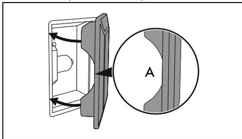
7. Нажмите на крышку таким образом, чтобы она плотно прилегала к патрону лампочки.
