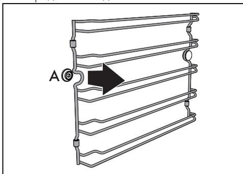
3. Снимите рамку с заднего стержня B, расположенного в глубине на боковой стенке.
