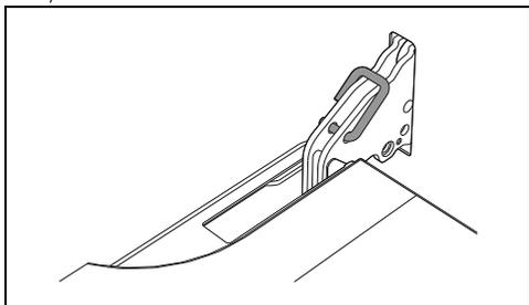
2. Взять дверцу за обе стороны двумя руками рядом с петлями, приподнять ее под углом приблизительно  $30^\circ$  и вынуть.
