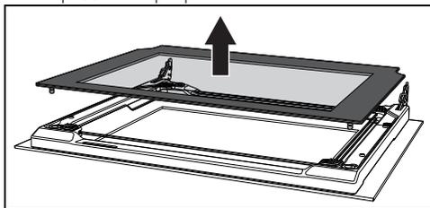
5. Снимите промежуточный стеклянный блок в направлении низа дверцы и затем приподнимите его вверх.
