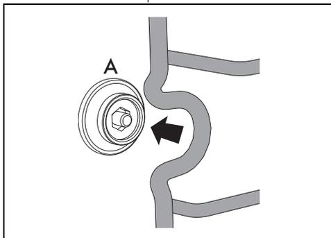
3. Apertar o perno de fixação dianteiro (é possível ajudar-se com um utensílio, por exemplo uma moeda).
