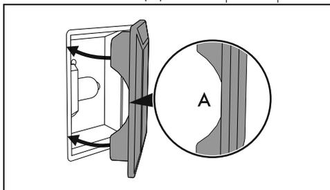
7. Pressione totalmente a tampa de forma a que encaixe perfeitamente no suporte da lâmpada.
