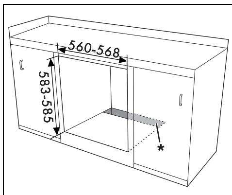
\* Убедитесь, что в нижней/задней части мебели имеется отверстие глубиной примерно 60 мм.
