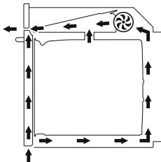
Вентилятор отвечает за охлаждение прибора и включается во время приготовления.
