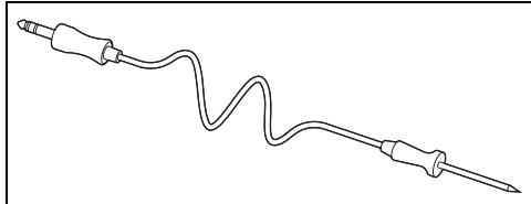
Термощуп позволяет приготовить блюдо на основании температуры, измеренной внутри него.
