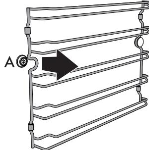
3. Снимите рамку с заднего стержня В, расположенного в глубине на боковой стенке.
