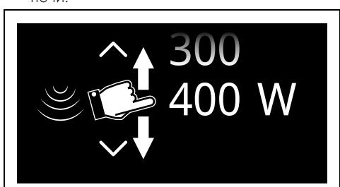
Мощность микроволновой печи: от 100 Вт до 400 Вт.
