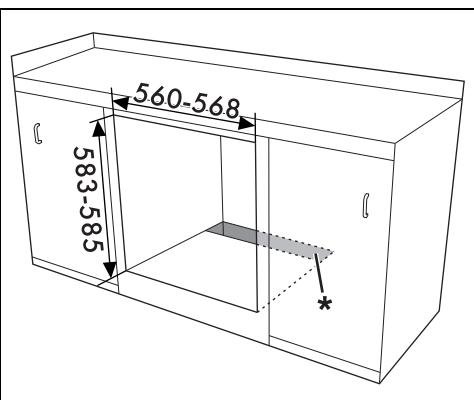
\* Убедитесь, что в нижней/задней части мебели имеется отверстие глубиной примерно 60 мм.
