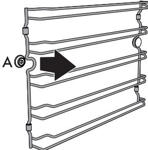
3. Снимите рамку с заднего стержня B, расположенного в глубине на боковой стенке.
