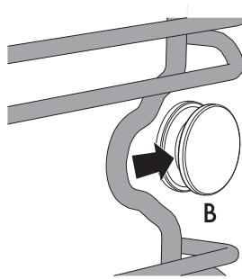
2. Вставьте переднюю часть рамки в гнездо A на боковой стенке рядом в отверстием рабочей камеры.
