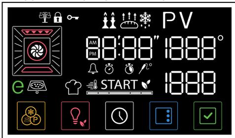
На дисплее отображаются параметры и значения, касающиеся выбранной функции. Для его использования достаточно нажать на сенсорные кнопки на панели управления или на кнопки в нижней части экрана, в зависимости от операций, которые должен выполнить прибор.
