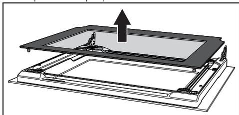
5. Снимите промежуточный стеклянный блок в направлении низа дверцы и затем приподнимите его вверх.
