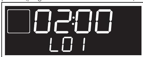
3. Gire el mando de la temperatura para programar la duración de la pirólisis entre un mínimo de 2 horas hasta un máximo de 3 horas.
