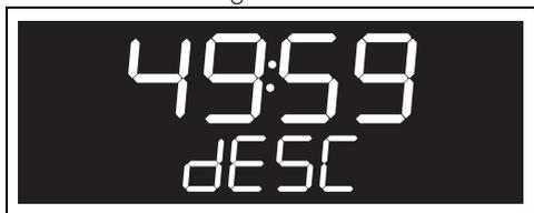
Una vez finalizado el proceso de descalcificación, el aparato emite una señal acústica y la pantalla muestra la petición de
