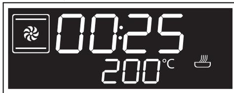
3. Pulse el mando de la temperatura. En la pantalla aparece parpadeando la hora sugerida para una cocción inmediata.
