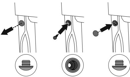
1. Снимите заглушки втулки, находящиеся в передней части духовки.
