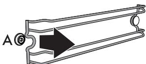
3. Снимите рамку с заднего стержня B, расположенного в глубине на боковой стенке.
