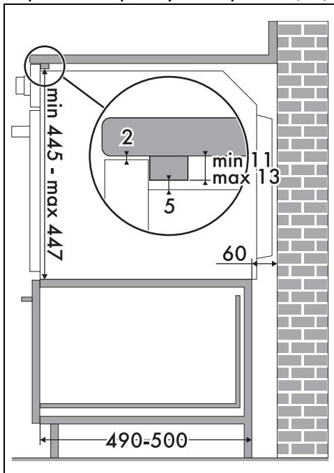
Если вы намереваетесь утопить прибор в рабочую поверхность, следует закрепить деревянный брускок для обеспечения надлежащей работы клейкого уплотнения, приклеиваемого на переднюю панель сзади для предотвращения проникновения влаги или других жидкостей.
