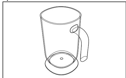
Он служит для хранения жидкости при заполнении и опустошении резервуара.
