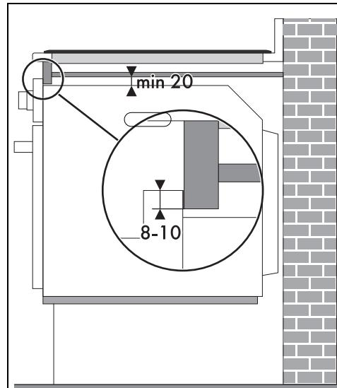
Снизу полки следует закрепить деревянный бруск для обеспечения надлежащей работы клейкого уплотнения, приклеиваемого на переднюю панель сзади для предотвращения проникновения влаги или других жидкостей.
