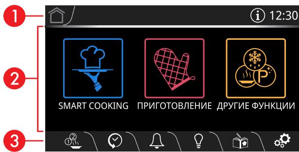
На дисплее отображаются параметры и значения, касающиеся выбранной функции. Для их использования достаточно коснуться "виртуальных" кнопок и/или пролистать
