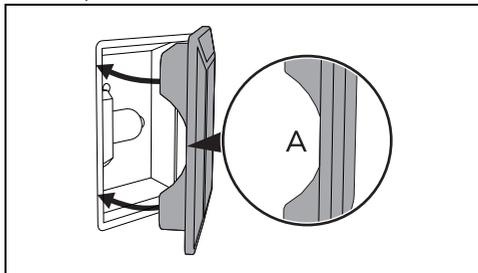
7. Нажмите на крышку таким образом, чтобы она плотно прилегал к патрону лампочки.
