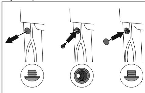
1. Снимите заглушки втулки, находящиеся в передней части духовки.
