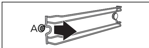
3. Снимите рамку с заднего стержня В, расположенного в глубине на боковой стенке.
