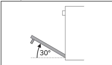
3. Чтобы снова установить дверцу, вставьте шарниры в соответствующие пазы, расположенные на духовке, так чтобы шлицы А полностью вошли в пазы.
