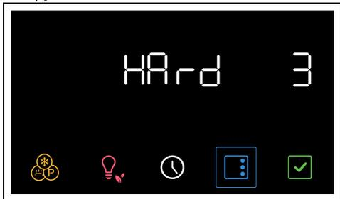
2. Поверните ручку регулировки температуры, чтобы установить жесткость воды (значения от 1 до 5) (например, «1»).
