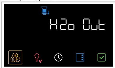
Вода начнет вытекать в глубокий противень противень из сливной трубки, расположенной на правой стороне задней стенки рабочей камеры.
