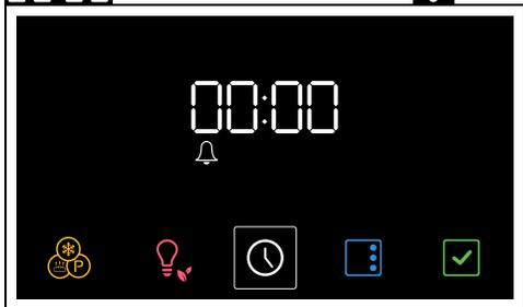
2. Поверните ручку температуры, чтобы установить время таймера (от 1 минуты до 23 часов).
