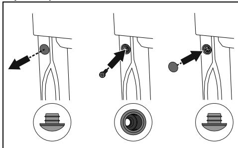
1. Снимите заглушки втулки, находящиеся в передней части духовки.
