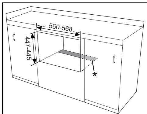
\* Убедитесь, что в нижней/задней части мебели имеется отверстие глубиной примерно 60 мм.
