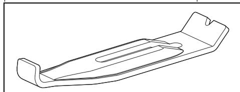
Чтобы правильно закрепить варочную панель на тумбе для встраивания, ввинтите крепежные кронштейны в специальные отверстия.
