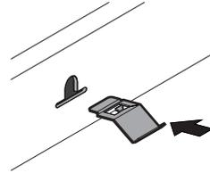
2. Затем поверните их кверху для окончательной фиксации.
