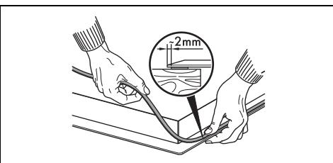
**!** Не закрепляйте варочную панель при помощи силикона, так как это приведет к повреждению варочной панели в случае ее демонтажа.
