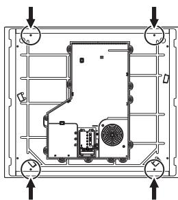
2. Для правильного крепления варочной панели к конструкции ввинтите крепежные кронштейны (A) в отверстия, намеченные ранее удаленными винтами.
