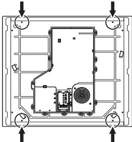
2. Для правильного крепления варочной панели к конструкции ввнитте крепежные кронштейны (A) в отверстия, намеченные ранее удаленными винтами.
