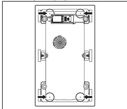
2. Для правильного крепления варочной панели к конструкции ввинтите крепежные кронштейны (A) в отверстия, намеченные ранее удаленными винтами.
