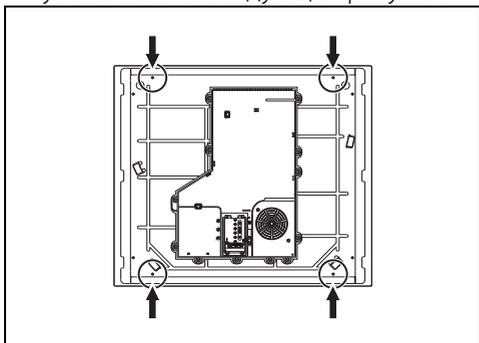
2. Для правильного крепления варочной панели к конструкции ввинтите крепежные кронштейны (А) в отверстия, намеченные ранее удаленными винтами.
