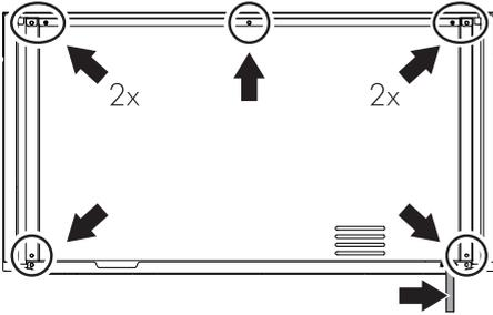
**Posizione delle viti e del cavo di alimentazione
