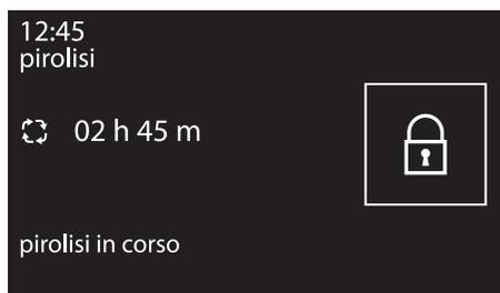
2. Alla fine della pirolisi, la porta rimane bloccata fino a quando la temperatura all'interno del vano cottura torna a livelli di sicurezza.
