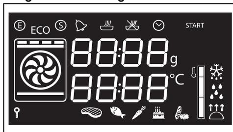
Il display mostra i parametri e i valori relativi all'operazione attualmente selezionata. Per utilizzarlo è sufficiente ruotare la manopola funzioni e la manopola temperatura per selezionare i valori indicati.
