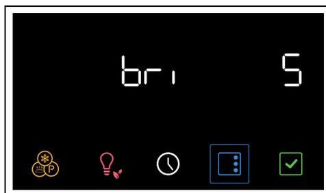
2. Rodar o botão da temperatura para a direita ou para a esquerda para seleccionar a luminosidade desejada, do valor 1 (baixa luminosidade) até ao valor 5 (alta luminosidade).
