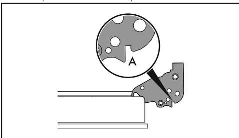
4. Baixe a porta e em seguida remova os parafusos dos orifícios das dobradiças.
