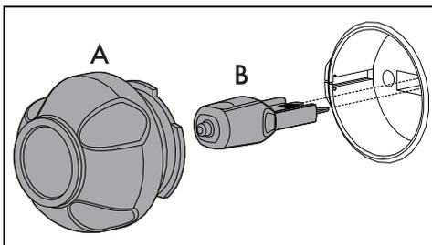
3. Substitua a lâmpada (B) por uma semelhante (25W). Use unicamente lâmpadas para forno (T 300°C).
