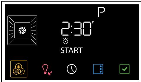
3. Rodar o manípulo da temperatura para definir a duração da Pirólise de um mínimo de 2:00 horas até um máximo de 3:00 horas.
