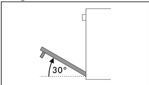
3. Para voltar a montar a porta, introduza as dobradiças nas respetivas fendas situadas no forno assegurando-se de que os sulcos **A** fiquem totalmente apoiados nas fendas.
