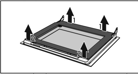
3. Décrochez les taquets avant en suivant le mouvement indiqué par les flèches (2).
