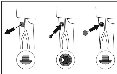
1. Enlevez les bouchons des douilles introduits à l'avant de l'appareil.
