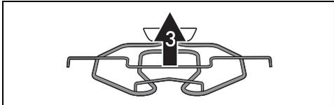
Volte a colocar a base de apoio da placa para pizza empurrando-a até à parte de trás do forno e baixe-a até que a pequena placa da resistência encaixe na base da mesma.
